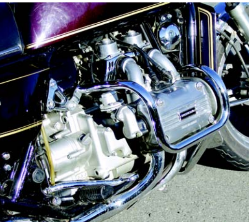
El motor es de 4 cilindros opuestos alimentados por 4 carburadores Keihin de 31mm. A la GL '78 se incorporó un nuevo tablero con relojes de combustible, temperatura y corriente. El lugar del tanque lo ocupaban una guantera, el depósito del refrigerante y el sistema eléctrico.
