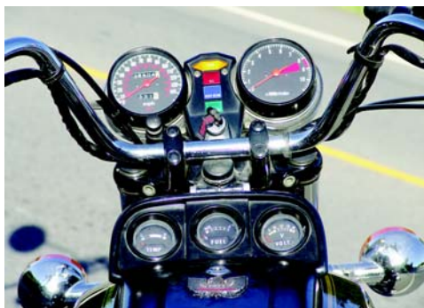
El motor es de 4 cilindros opuestos alimentados por 4 carburadores Keihin de 31mm. A la GL '78 se incorporó un nuevo tablero con relojes de combustible, temperatura y corriente. El lugar del tanque lo ocupaban una guantera, el depósito del refrigerante y el sistema eléctrico.
