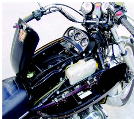
El motor es de 4 cilindros opuestos alimentados por 4 carburadores Keihin de 31mm. A la GL '78 se incorporó un nuevo tablero con relojes de combustible, temperatura y corriente. El lugar del tanque lo ocupaban una guantera, el depósito del refrigerante y el sistema eléctrico.
