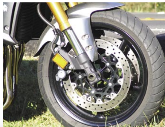
El basculante de aluminio con refuerzo superior es heredado de la R1. La horquilla de barras invertidas, los frenos de disco con anclaje radial y los rines también son herencia de su prima súper deportiva y tienen un comportamiento bestial.
