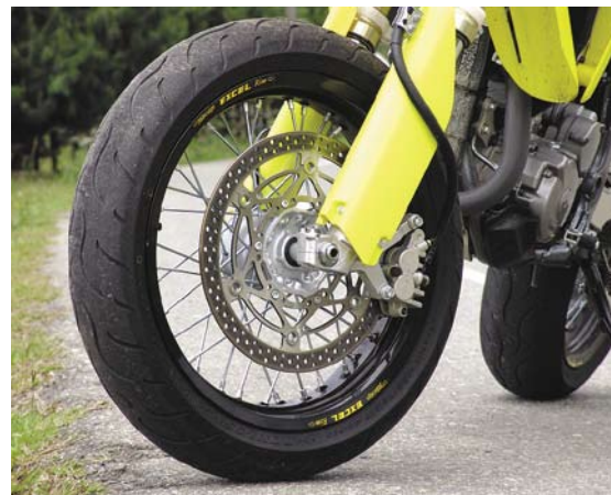
Las Dunlop D208 le dan muy buen agarre sobre todo tipo de asfalto. El disco delantero de 310mm es un prodigio de frenado y el trasero de 240mm no se le queda atrás. Abajo: vista de frente se puede apreciar su esbelta silueta.
