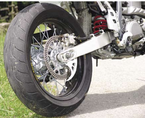
Las Dunlop D208 le dan muy buen agarre sobre todo tipo de asfalto. El disco delantero de 310mm es un prodigio de frenado y el trasero de 240mm no se le queda atrás. Abajo: vista de frente se puede apreciar su esbelta silueta.
