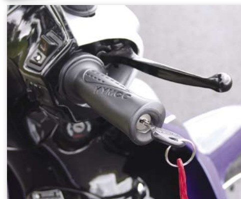
Opcionalmente se puede montar una parrilla ideal para trabajo pesado. Un detalle ingenioso que brinda seguridad es el bloqueo del acelerador.
