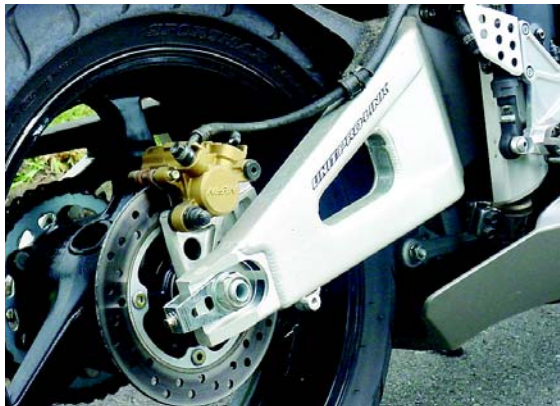
Una de las piezas más hermosas de la "Rossi Replica" es la imponente tijera de aluminio.
