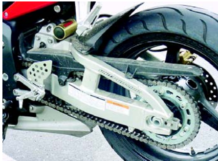
El cilindro dorado es el tanque de gas del amortiguador que esta ubicado ingeniosamente en el centro de la tijera.
