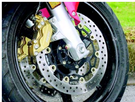
El poder de frenado del doble disco con pinzas Nissin de 4 pistones es magnífico.
