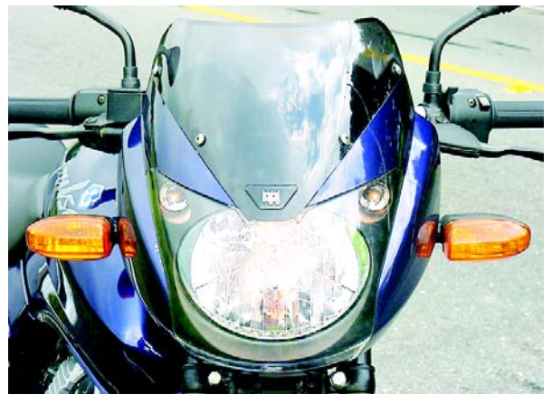
El cambio más notorio en la nueva Pulsar DTS-i es el faro multifocal y su aerodinámico carenado que le cambia por completo el aspecto a esta monocilíndrica
