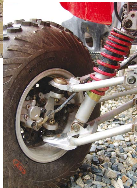
Sobre estas líneas se puede ver en detalle la suspensión delantera independiente de doble tijera, así como la mordaza del disco delantero y el amortiguador ajustable en precarga.
