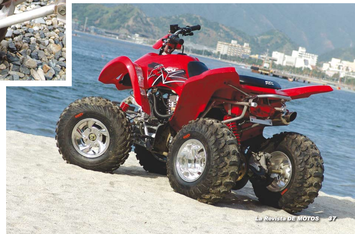
Sobre estas líneas se puede ver en detalle la suspensión delantera independiente de doble tijera, así como la mordaza del disco delantero y el amortiguador ajustable en precarga.
