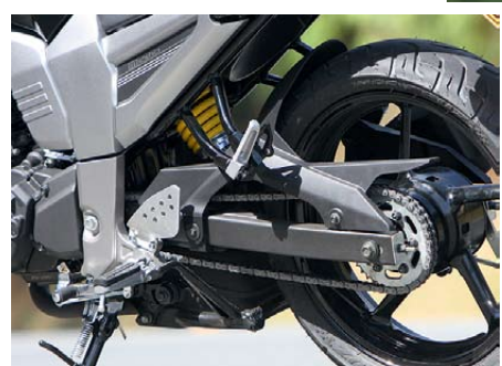
El tablero es moderno y bien presentado aunque cuesta un poco visualizarlo de día. El guardacadena unido al gurdabarro interno le imprime robustez al basculante. La tapa del tanque sin bisagra termina rodando por el suelo.
