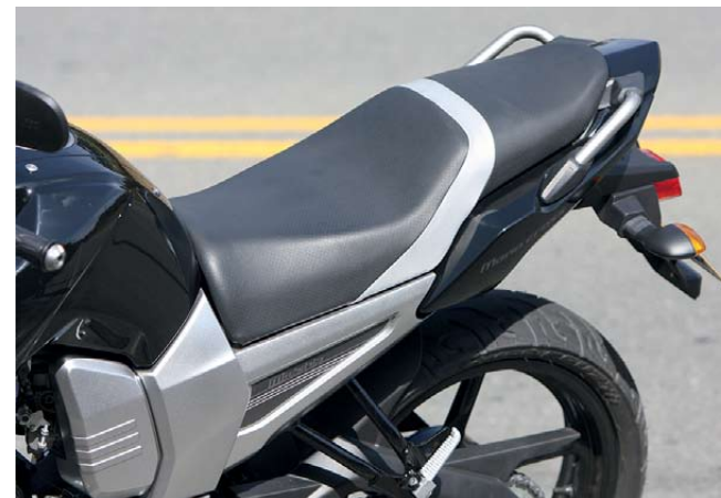
Izquierda, silla a dos colores y doble nivel con las asas laterales espléndidamente vinculadas al concepto de la moto. Derecha, arriba, amortiguador trasero tipo Monocross. El novedoso escape no pasa desapercibido. Gran potencia y dosificación mostró el freno de disco delantero.
