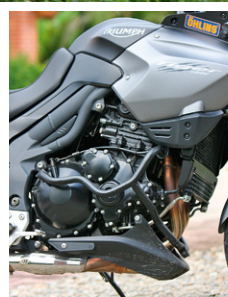
Arriba se puede ver el musculoso y compacto tricilíndrico de 1.050cc. Abajo el doble disco con pinzas radiales y discos flotantes de 320mm. En la página opuesta se ve el robusto basculante trasero, la afilada cola con el escape saliendo por arriba y por último el tablero digital y análogo.
