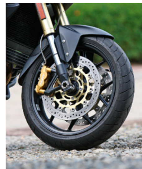
Arriba se puede ver el musculoso y compacto tricilíndrico de 1.050cc. Abajo el doble disco con pinzas radiales y discos flotantes de 320mm. En la página opuesta se ve el robusto basculante trasero, la afilada cola con el escape saliendo por arriba y por último el tablero digital y análogo.
