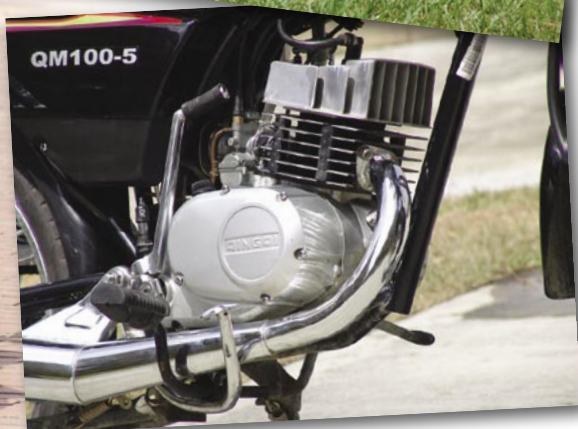
La frenada es uno de los aspectos más destacables de la QM100 por la efectividad de su disco delantero. El motor es un 2T de 100cc, que entrega 8 caballos a 7.000rpm.
