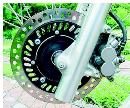
El disco perforado, con pinza de doble pistón permite detener la moto muy poco espacio.
