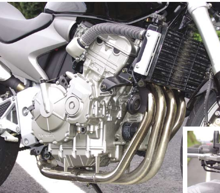
El compacto tetracilíndrico entrega 95hp a 12.500rpm y se destaca por su suavidad a bajo y medio régimen. La farola de doble bombillo está muy bien lograda, pero las direccionales ya lucen algo quedadas en diseño. La frenada esta a cargo de 2 discos flotantes de 296mm.
