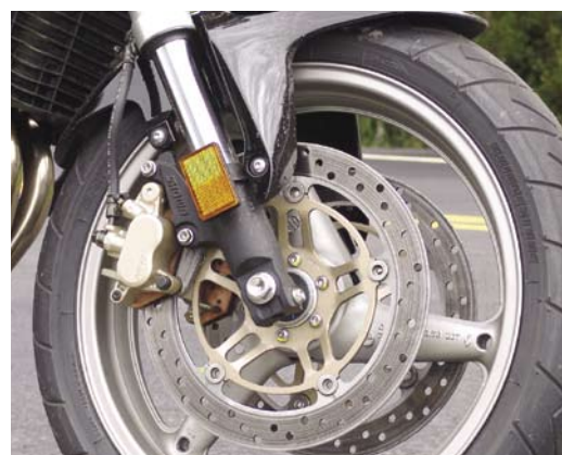
El compacto tetracilíndrico entrega 95hp a 12.500rpm y se destaca por su suavidad a bajo y medio régimen. La farola de doble bombillo está muy bien lograda, pero las direccionales ya lucen algo quedadas en diseño. La frenada esta a cargo de 2 discos flotantes de 296mm.
