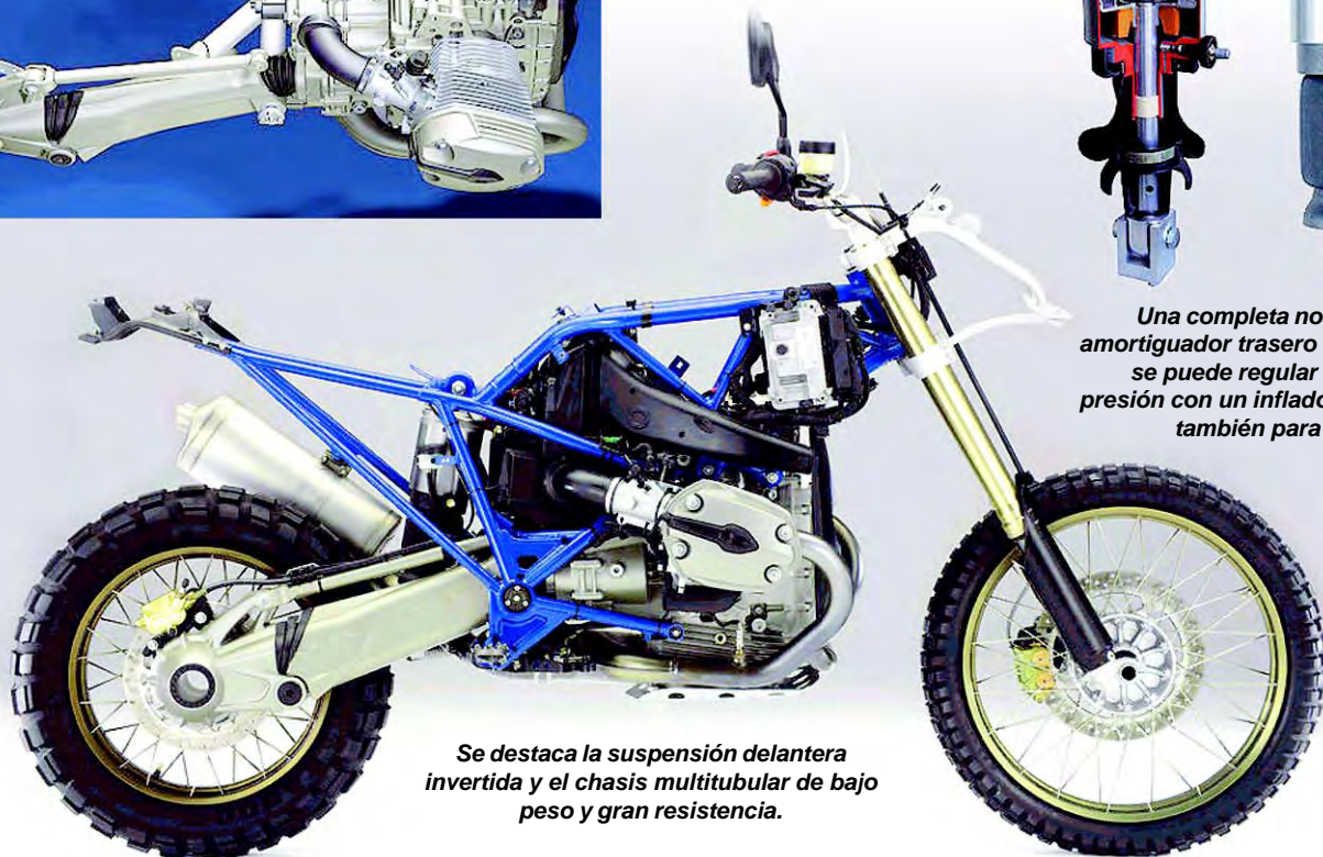
El motor de la GS 1200 ha sido modificado para dar 105 caballos y la transmisión fue reforzada para soportar el mayor castigo que tendrá en uso off-road.
