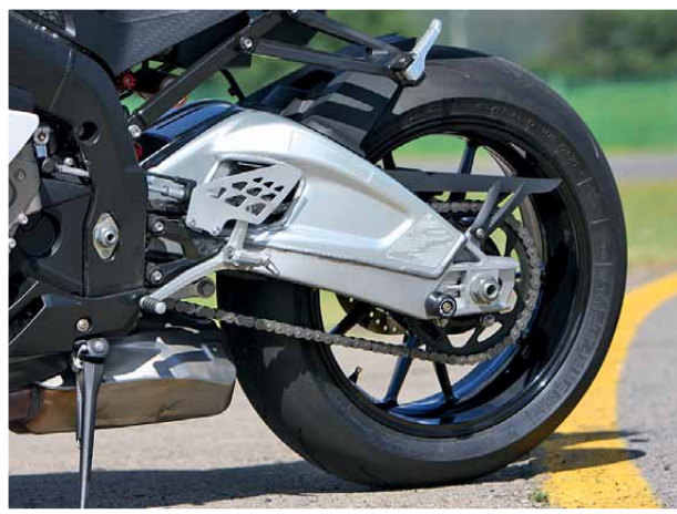
El motor reúne mucha de la experiencia de BMW en F1. En total pesa solo 59,8 kilos. Abajo el hermoso basculante de aluminio.
