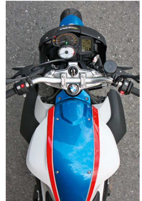
Arriba se aprecia el completísimo cuadro de instrumentos de la F 800R y el falso tanque que es una cubierta plástica.
